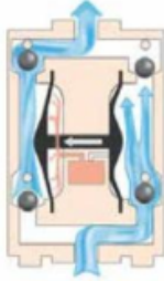
ŞEMA-1: HAVA DİYAFRAMLI POMPA GENEL ÇALIŞMA PRENSİBİ
